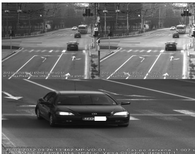
Obrázok 3: Umiestnenie kamier systému UnicamREDLIGHT (detailová kamera - vľavo; prehľadová kamera - vpravo)
