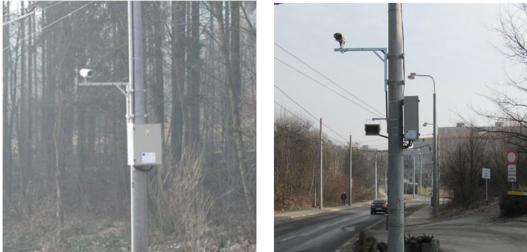
Obrázok 1: Umiestnenie kamier systému Unicam VELOCITY (kamera na vstupe - vľavo; kamera na výstupe - vpravo)
